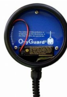
電池交換は背面の蓋を開け 9V 電池を交換します。
