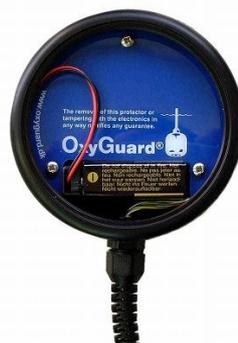
電池交換は背面の蓋を開け9V形アルカリ電池を交換します。
