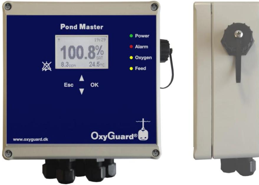
OxyGuard PondMaster は球形 DO 電極用連続式溶存酸素計で、養殖池用に開発されました。DO 及び温度の LCD 表示器、3 点の警報接点に加えロガー機能を持っています。電極の出力は長期安定で、隔膜・電解液の交換スパンが長く、汚れの除去以外は殆どメンテナンスを必要としません。マイクロプロセッサーを搭載し表示単位も溶存 ppm/溶存% の表示切替が簡単に行えます。ログ機能で記録したデータの回収は USB メモリを横のインターフェースに差すだけでテキスト形式のデータが転送されます。
