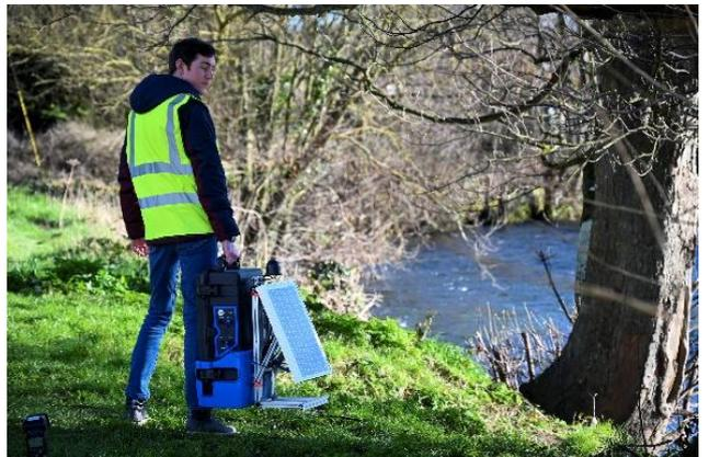
Aquamonitrix は水産養殖や RAS での使用に特化した硝酸塩・亜硝酸塩リアルタイムモニタリング装置です。本製品ではイオンクロマトグラフィーの分離能力と独自の UV-LED 検出器を組み合わせることで硝酸塩濃度が高い場合や海水中でも、亜硝酸塩を極めて正確に読み取ることを実現しました。また、溶離液には NaCl を用いているので無害で廃棄が簡単にでき、ランニングコストが抑えられます。測定したデータは即座に専用のクラウドに送信されるので、現場にいなくてもリアルタイムでデータの確認ができます、専用クラウド以外にもシリアル通信でのデータ出力にも対応しており変換器を経由して 4~20mA 出力で OxyGuard 社製 Pacific や PLC に取り込めます。また、専用のソフトウェアを使用することでユニットに保存されたデータの確認やサンプリング設定の変更が行えます。装置には監視用のセンサが 8 種類搭載されており異常があればクラウド上ですぐに確認できます。
