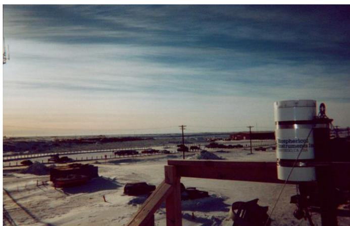
GUV-511 型では紫外域と PAR のみの測定しかできませんでしたが、紫外から赤外域までの広範囲から 19 チャンネル選択できるようになりました。紫外域はそれまでのシリコン(Si)フォトダイオードに代えて、より紫外線の検知感度が高い炭化ケイ素(SiC)フォトダイオードを採用(オプション)しています。また、温度変化によるフォトダイオードの光測定の不確かさを軽減するために定温制御機能を備えおり、40° と 50° のどちらかを選ぶので赤道から極域まで広範囲に使用できます。
