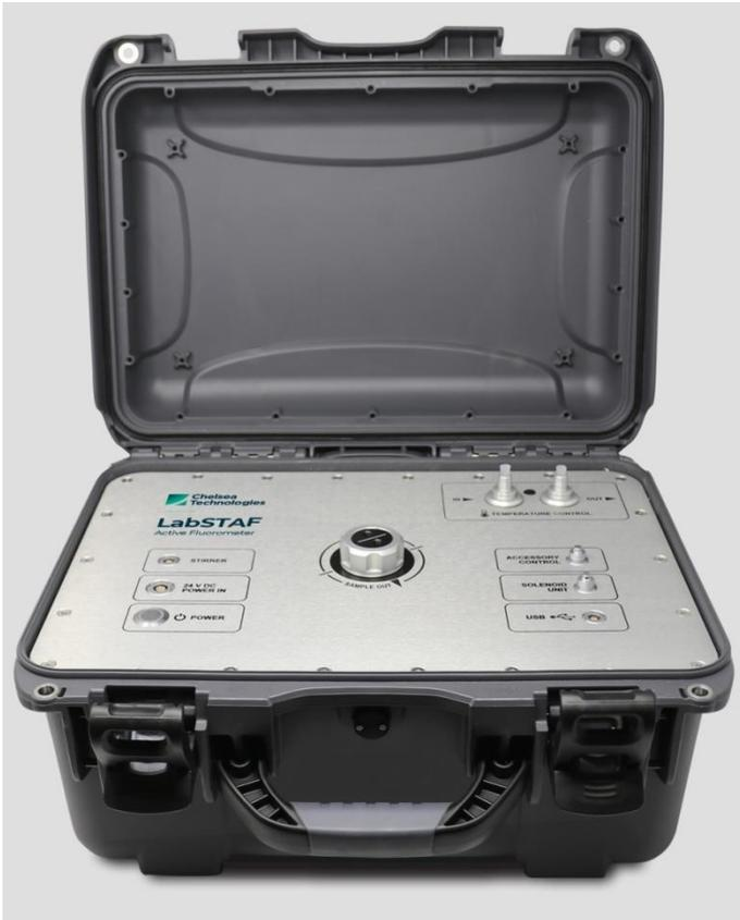
LabSTAF 型は、Single Turnover Active Fluorometry(シングルターンオーバーアクティブ蛍光法)を用いて植物プランクトンの一次生産(PhytoPP)を測定するチェルシー社の最新卓上型蛍光光度計です。励起波長は現場型 FRR 蛍光光度計 FastOcean の 3 波長から 7 波長にし、検出波長を 1 波長から 2 波長にすることで、光合成測定のスเปクトル補正や群衆構造の評価、パッケージ効果によるクロロフィル蛍光光度の再吸収誤差の補正を可能としました。また、励起パルスは FastOcean の 1 $\mu$  秒の閃光から個体励起パルスとし、さらに光学系を変更することで一桁以上の感度向上がなされ、極端な貧栄養条件下での測定を可能となりました。
