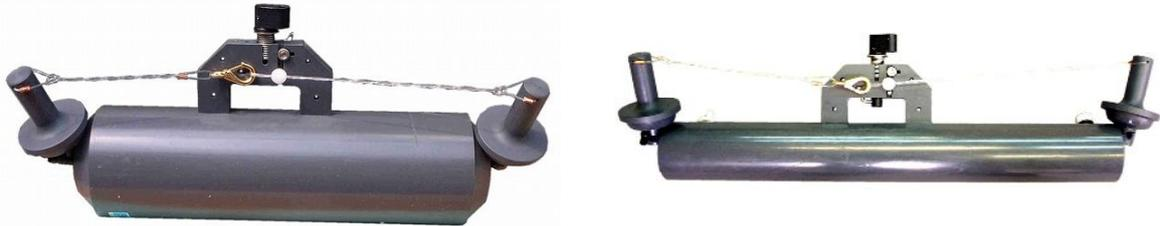
ニスキン採水器の改良型として、水平ニスキン採水器が発売されました。ニスキン採水器を横にしても作動するように考えられた、ボトムや表層採水専用の採水器です。
