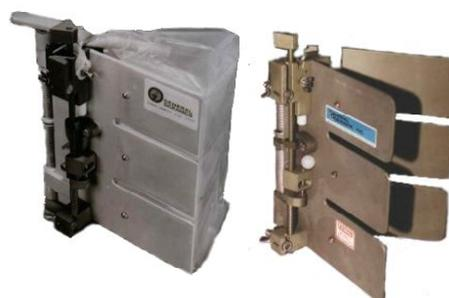
蝶番式の開閉器に無菌袋1.5Lをはめて採水します。ナイフで袋の口を切り採水後クランプで採水口を塞ぎます。
