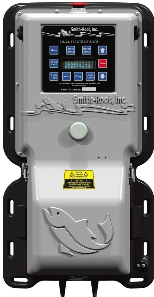
魚を捕獲する方法として、電気が利用できることは広く知られています。スミスルート社のエレクトロフィッシャーは一旦捕獲した魚を再度リリースする研究目的で製作された電撃器で、魚を傷めないように直流や、いろいろな周期、パルス幅の交流を発生できるよう工夫されています。これは、魚が交流と直流では反応が全く異なり、直流のプラス側に向かってくる性質を利用する為です。LR-24型には従来のModel-12BにはなかったAuto-Setup機能が組み込まれ、今まで面倒だった設定を、使用する水の電導度に合わせ自動で設定できるようになっています。
