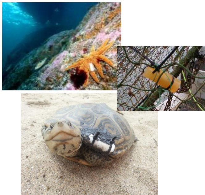
電導度センサ (一対の電極で測定)
