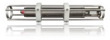
音速を音響で直接計測する Time of Flight 法 と塩分や密度から計算からされた音速を同時 に比較できる CTD 音速プロファイラーです。 高精度 0.01%の深度センサーで深海までメモリー観測ができます。
